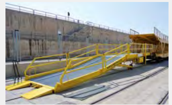
Rampa móvil para carga y descarga de trenes.
